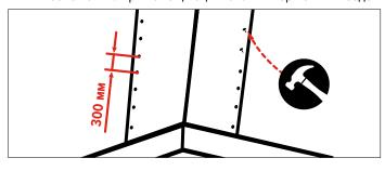
ВАЖНО! Монтаж производить на сухое, жесткое, ровное, влагостойкое, чистое от мусора и пыли основание. Перед монтажом следует подождать, когда каркас деревянного здания и само деревянное основание произведет усадку по всей своей площади (отдаст накопленную влагу), дабы исключить возможность образования волн и неровностей на смонтированной кровле. Монтаж материала осуществлять при температуре основания и наружного воздуха от +10 °C.
