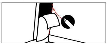
**1.3** Аналогичным образом смонтировать вторую половину материала. Выполнить механическое крепление по краям и в зоне конька при помощи оцинкованных ершеных гвоздей
